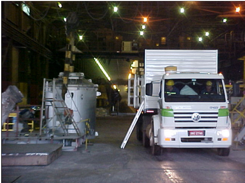
Figura 21: Carregamento de Alumínio Líquido
